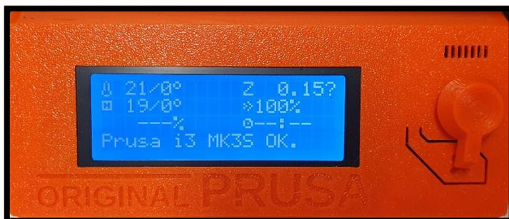
Vous pouvez y visualiser la température du plateau et de la tête d'impression. A droite, la molette « sélecteur » permet de naviguer dans les menus et juste en dessous un bouton reset.
